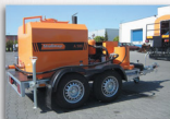
Depósito de emulsión con capacidad de 500 l, aislado, y calentado por quemador de gas.
