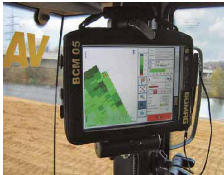
Control de compactación en toda el área con BCM 05.
