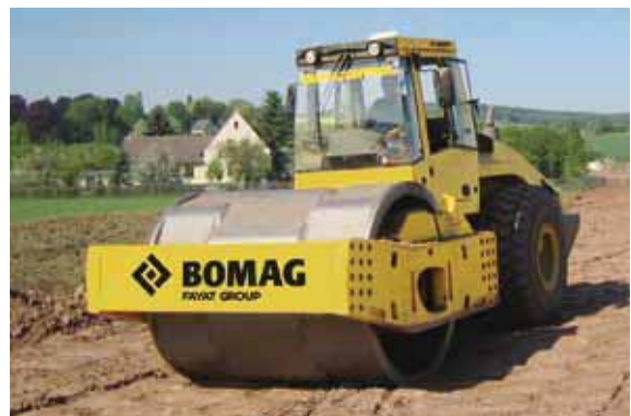
Rodillo autopropulsado con tambor poligonal realizando obras de tierra en una circunvalación.
