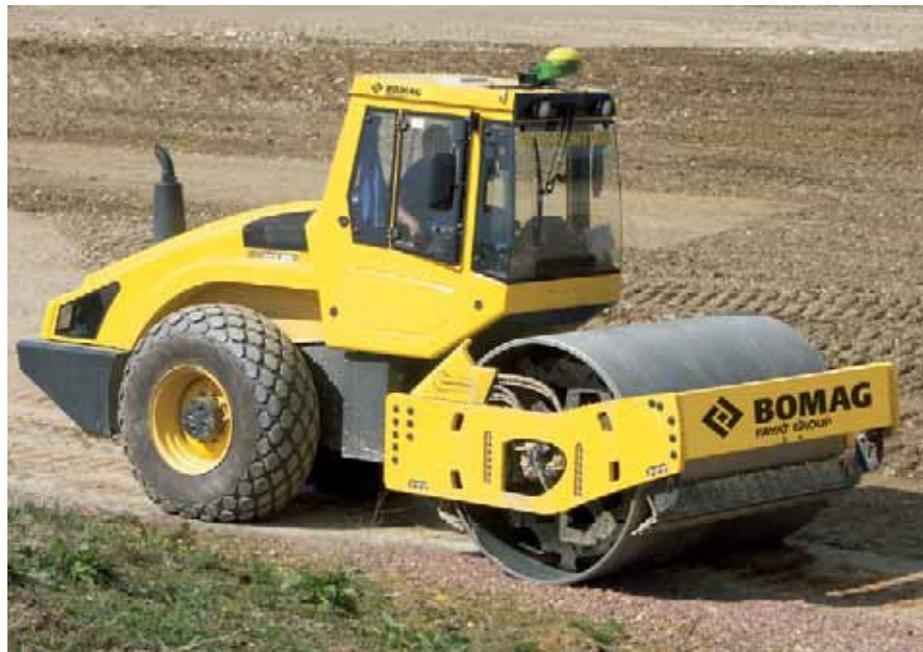
Control de compactación en toda la superficie con GPS. El sistema Starfire iTC-® de BOMAG consigue una elevada precisión y no necesita ninguna estación de referencia local.
