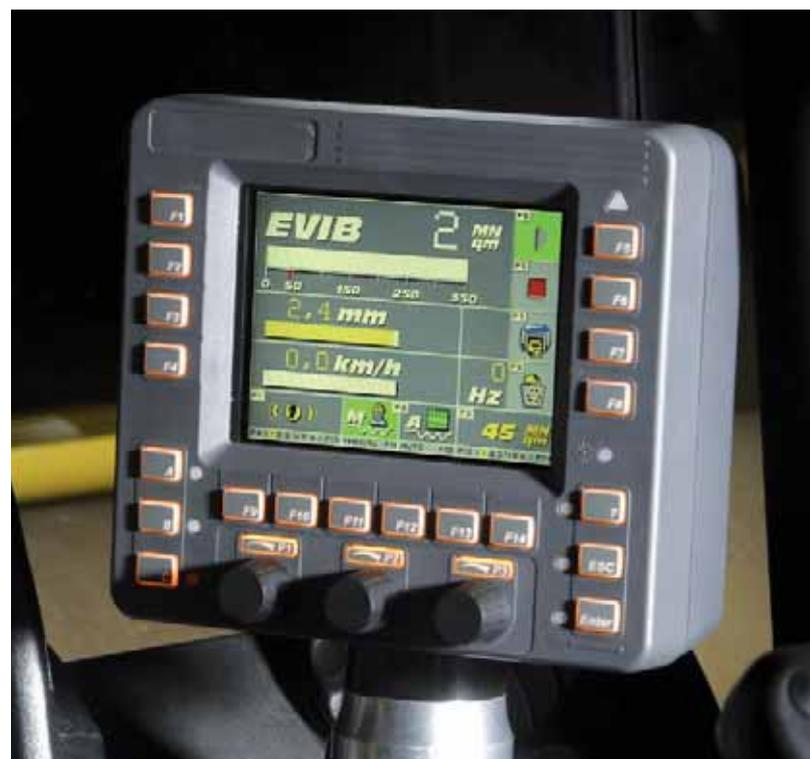
En la pantalla (el BW 177 BVC tiene otro diseño) el conductor ve de forma clara y sencilla cuándo el suelo ha alcanzado una compactación óptima.
