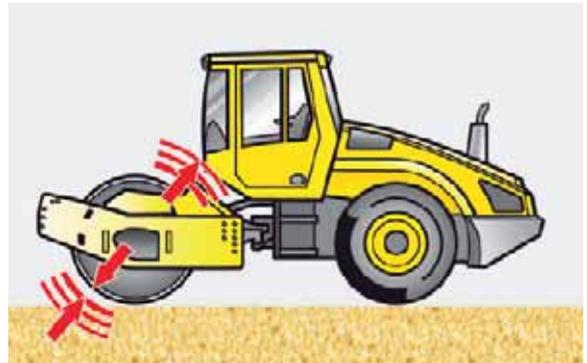
Posición angular = energía de compactación adaptada.
