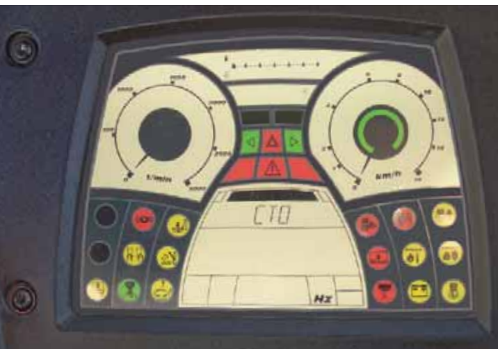
... así como pantalla LCD para rodillos con ASPHALT MANAGER de BOMAG.
