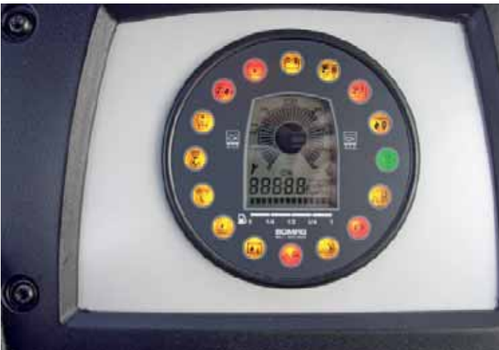
Moderna geometría de los instrumentos junto con indicadores digitales de todas las funciones más importantes. Como indicador redondo para rodillos de la versión AP ...
