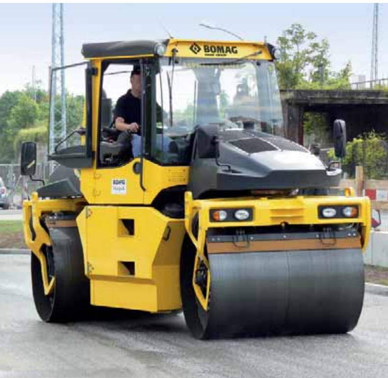
La marcha en cangrejo permite un desplazamiento de los tambores de hasta 1.350 mm a ambos lados.
