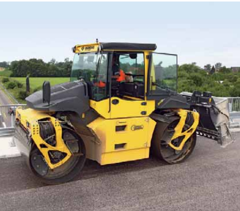
También es apto para aplicaciones „delicadas“: ASPHALT MANAGER 2 en un puente.
