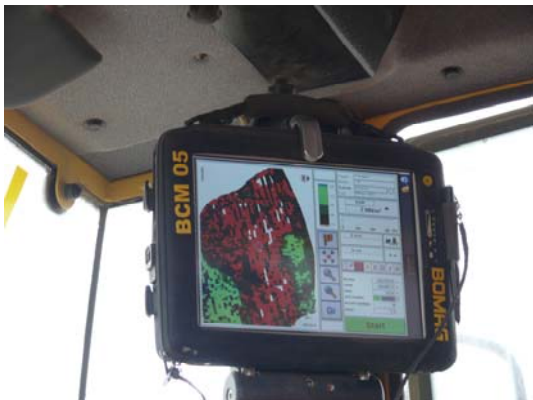
El Sistema de Gestión de Control BOMAG BCM 05 con GPS significa que el operador ve exactamente donde la compactación ha sido completada conjuntamente con los resultados producidos.
