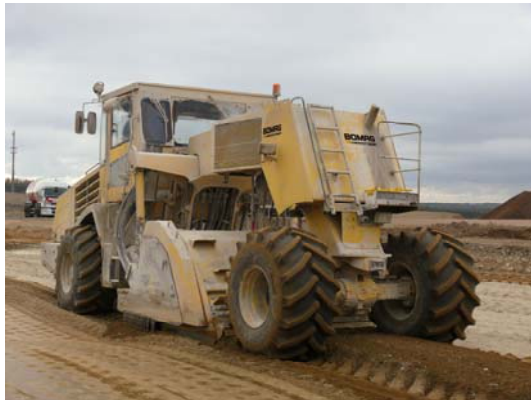
El BOMAG MPH 125 es altamente maniobrable gracias a la combinación de la articulación con la dirección en el eje trasero
